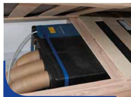
Vestavná klimatizace s rozvodem po karavanu.
